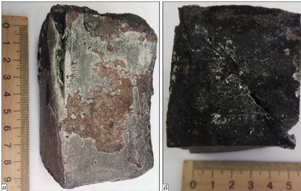
Рис. 4. Вид зливку дослідного сплаву Zr–Nb–Ti, отриманого способом дугового переплаву з невитратним електродом у гарнісажній печі, після деформаційної обробки (кування): a — з боку; б — з торця
