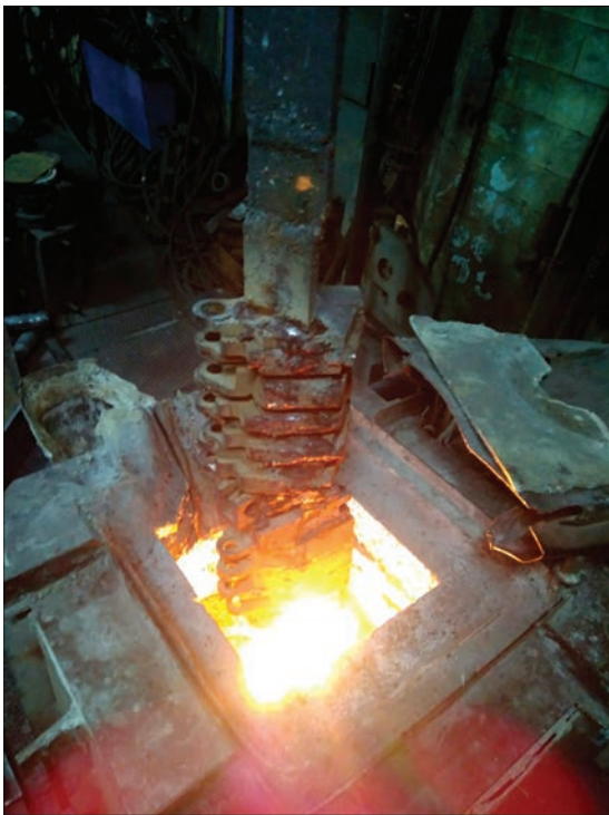
Рис. 3. Плавка електрода із кускового брухту в електрошлаковій тигельній печі
