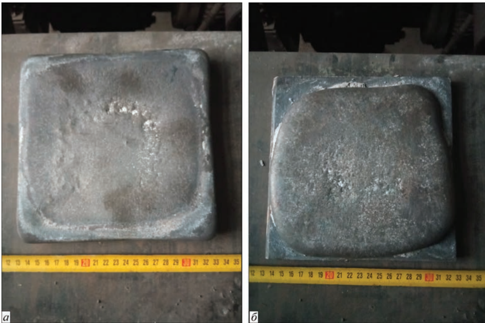
Рис. 3. Наплавлені шари, сформовані при ЕШП в ТПК квадратного перерізу з використанням флюсів АНФ-29 (а) та АН-26 (б)
