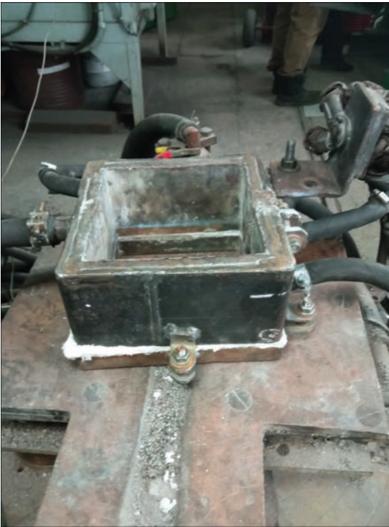
Рис. 1. Струмopідвiдний кристалiзатор з розмірами формувочної секції 200×200 мм
