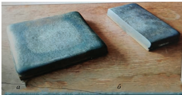
Рис. 4. Біметалічна заготовка зі сталі Ст 3 + високохромистий чавун, отримана ЕШН в ТПК перерізом 200×200 мм (а) та її поперечний переріз (б)
