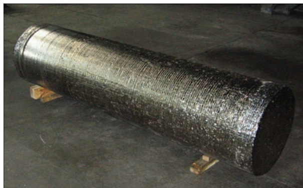
Рис. 1. Зливко сплаву ВТ9, отриманий способом ЕПП (рис. 1). Зливки отримували за технологією ЕПП з проміжною ємністю і порційною подачею рідкого металу в водоохолоджуваній кристалізатор.
