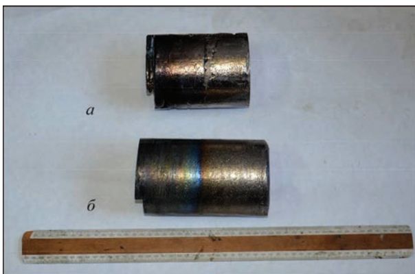
Рис. 3. Зовнішній вигляд поверхні злиwkів: а — переплавлений конгломерат титанових возгонів; б — переплавлені ливникові системи типу BT5-J
