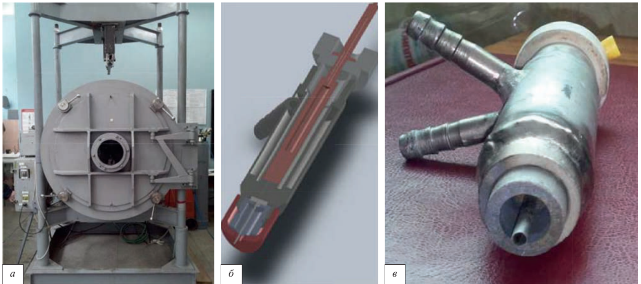
Рис.1. Зовнішній вигляд вакуумної камери (а) та плазмотрону (модель (б) і виготовлений за нею зразок (в)) для зварювання плазмове-емісійним розрядом у вакуумі
