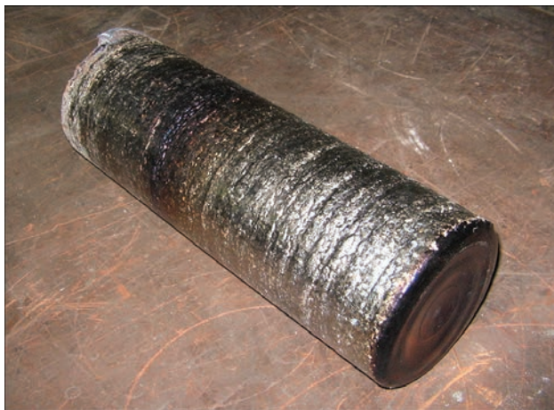
Рис. 2. Злинок ЕПП діаметром 200 мм алюмініду титану Ti-28Al-7Nb-2Mo-2Cr
