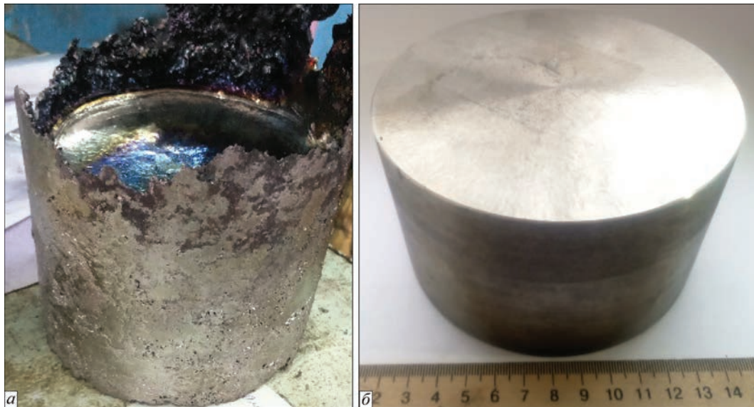
Рис. 3. Загальний вигляд зливка сплаву системи Zr–Nb–Ti після виплавки (а) та механічної обробки (б)
