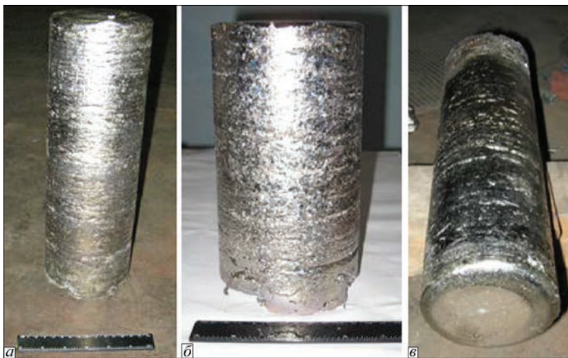
Рис. 2. Зливки титанових сплавів системи Ti-Al-Zr-Si-Mo-Nb-Sn діаметром 110 мм після ЕПП: а — плавка 812-208; б — плавка 814-208; в — плавка 815-208
