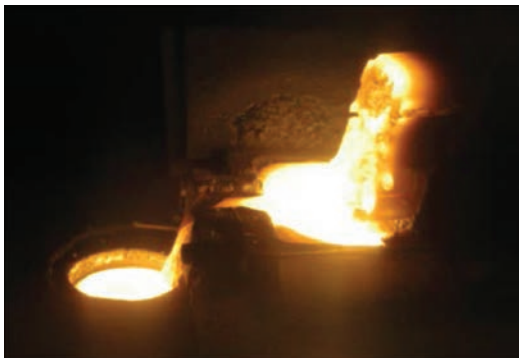
Рис. 1. Процес плавки зливка титанового сплаву системи Ti–Al–Zr–Si–Mo–Nb–Sn діаметром 110 мм в електронно-променевій установці
