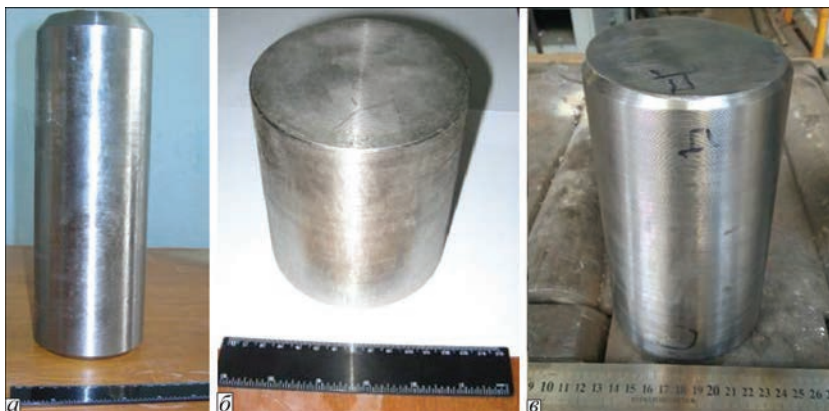
Рис. 3. Зовнішній вигляд зливок титанових сплавів системи Ti-Al-Zr-Si-Mo-Nb-Sn діаметром 110 мм після механічного оброблення бокової поверхні: а — плавка 812-208; б — плавка 814-208; в — плавка 815-208
