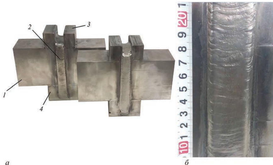
Рис. 2. Зовнішній вигляд зварних з'єднань (а) і поверхні шва (б): 1 — основний метал; 2 — шов; 3, 4 — технологічні планки
