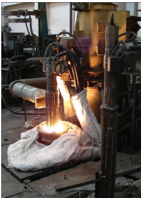
Рис. 3. Процес ЕШП дослідних електродів
