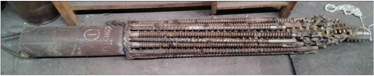
Рис. 2. Зовнішній вигляд дослідного електрода, зібраного з малогабаритного відпрацьованого інструменту зі сталі Р6М5
