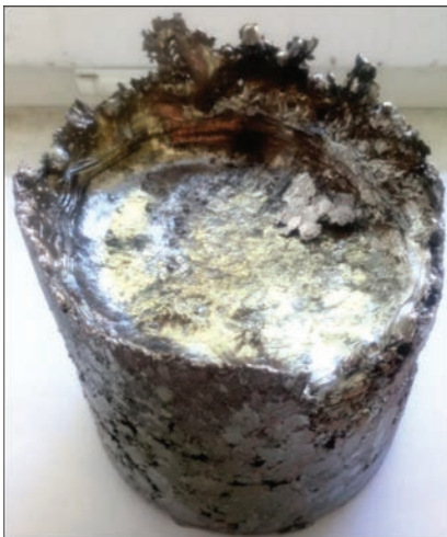
Рис. 3. Зовнішній вигляд зливка сплаву системи Zr–Nb–Ti після виплавки
