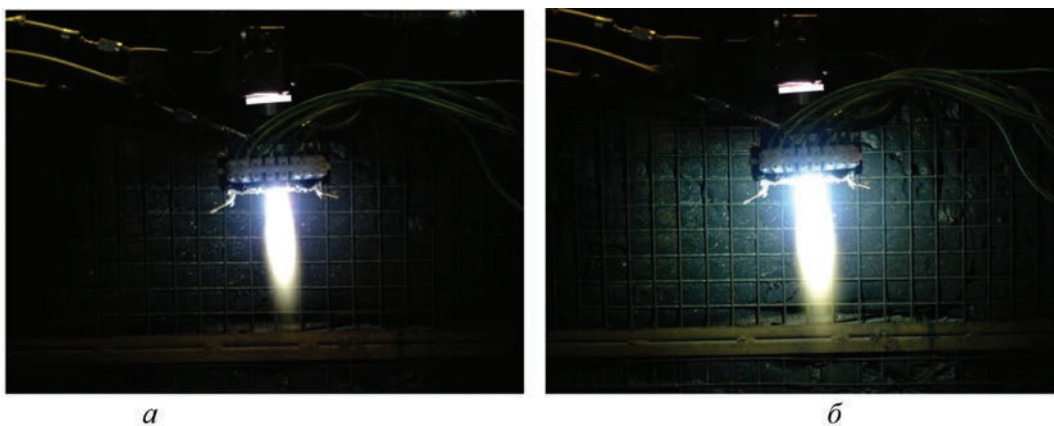
Рис. 4. Вигляд плазмового струменя*: a — без зовнішнього магнітного поля; б — із зовнішнім магнітним полем
