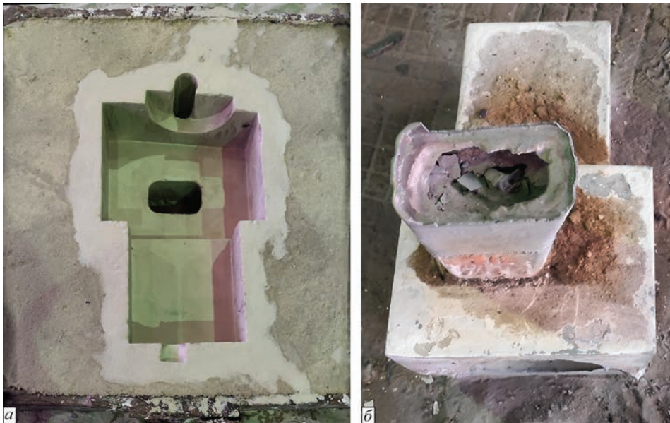
Рис. 5. Одержання масивних фасонних фторфлогопітових виливків: а — піщано-глиняна форма; б — фторфлогопітовий виливок для хлоратору «камінь льотки» загальною вагою 150 кг
