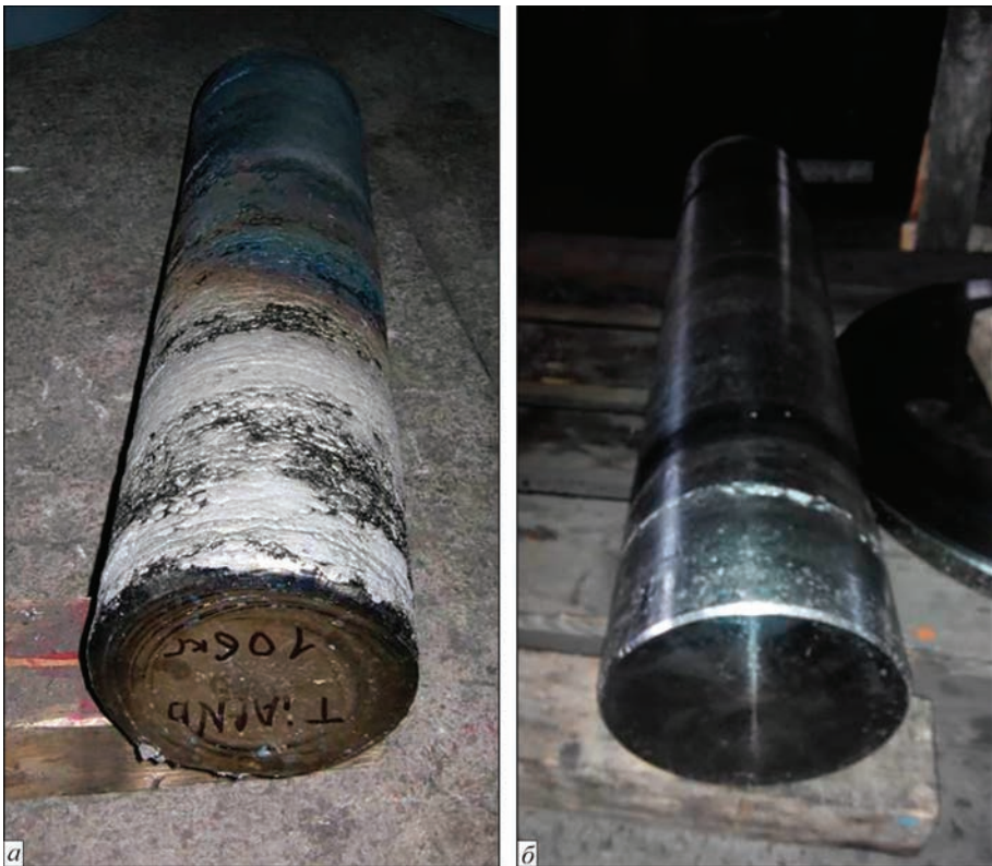
Рис. 5. Зовнішній вигляд зливка базового складу до механічної обробки (а) і після (б)
