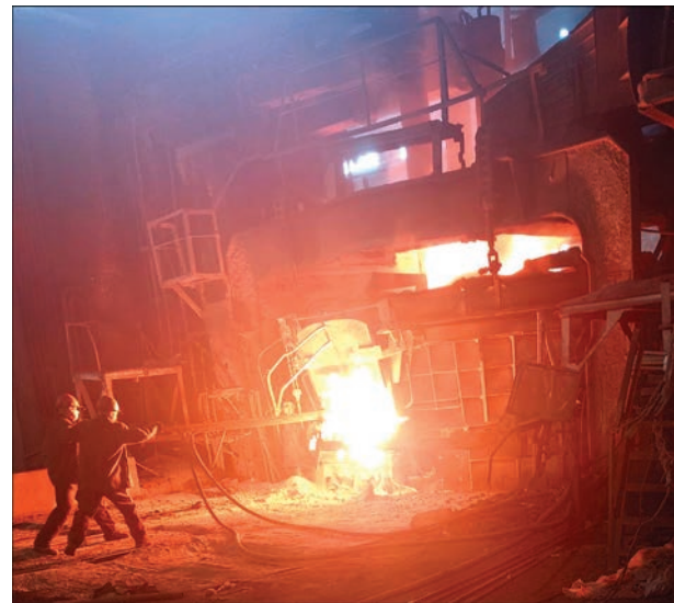
Рис. 2. Фрагмент роботи печі ДСВ-50 з гнотовими електродами діаметром 508 мм
