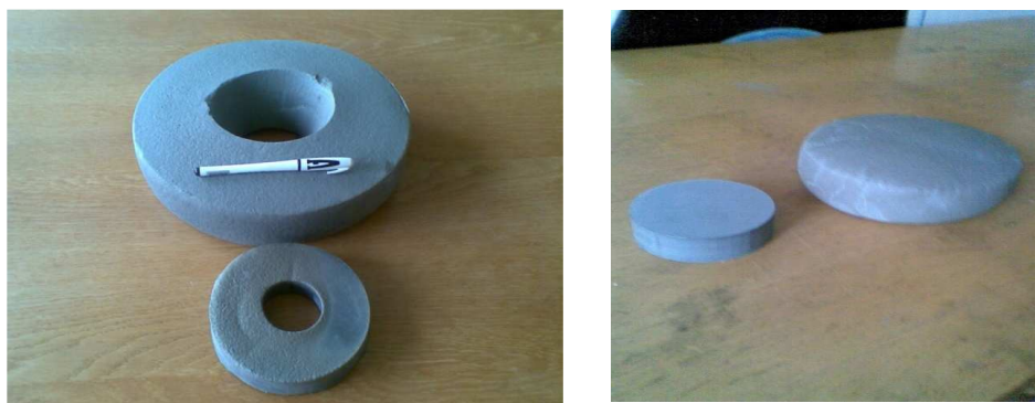
Рис. 4. Відтворення форми спресованих брикетів вихідної шихти в процесі формування структури піноскла.
