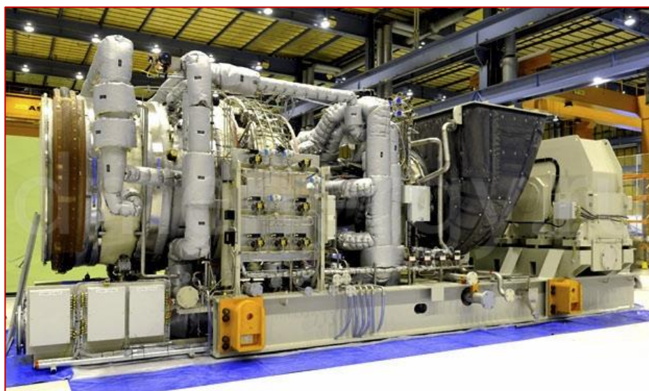
Рисунок 1. Газова турбіна «Siemens SGT600», електрична потужність 25 МВт [5]
