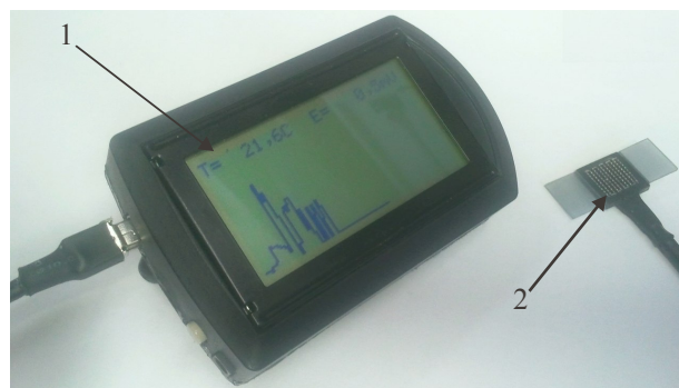
Рис. 1. Электронный регистратор с обработкой сигналов термоэлектрического сенсора теплового потока: 1 – электронный регистратор, 2 – термоэлектрический сенсор.
