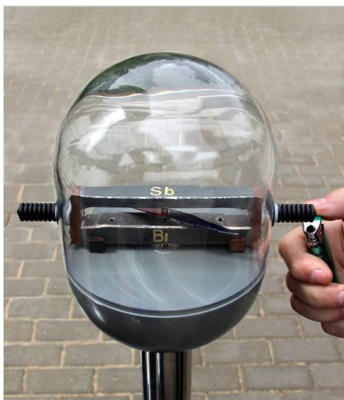
Действующая модель опыта Зеебека
