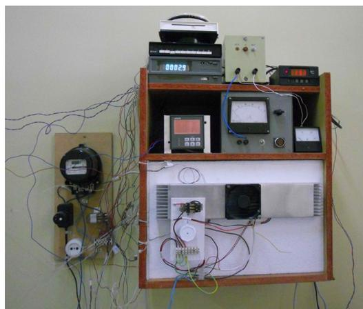
Рис. 1. Транспортный термоэлектрический холодильник (вид со стороны термоэлектрического агрегата) во время испытаний.
