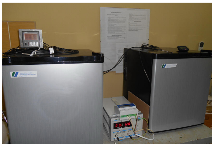
Рис. 1. Холодильники ChTT-48 в процессе лабораторных испытаний.
