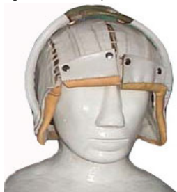
Рис. 11. Термоэлектрический прибор в виде шлема для охлаждения головы человека (Турция) [28].
