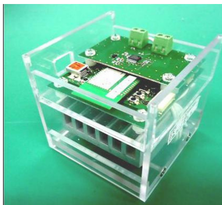
Рис. 9. Промышленный прототип встроенного в ТЭГЭЭ беспроводного сенсорного узла.
