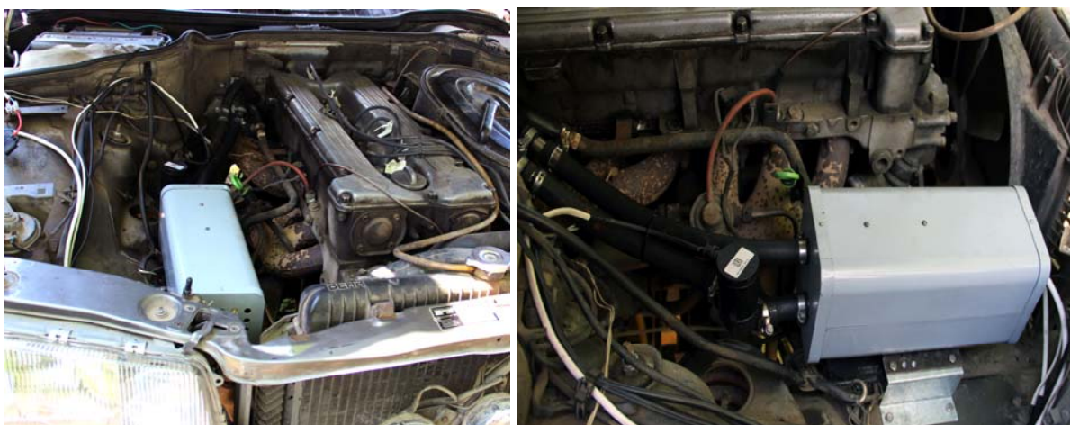
Рис. 8. Термоэлектрический предпусковой нагреватель на автомобиле «Mercedes».
