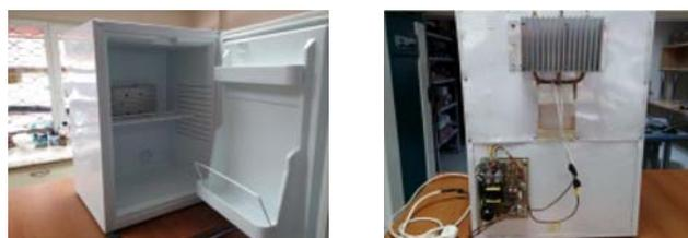
Рис. 7. Совместный проект ТУВИТАК и фирмы TES Ltd. «Термоэлектрический минибар с тепловой трубой».
