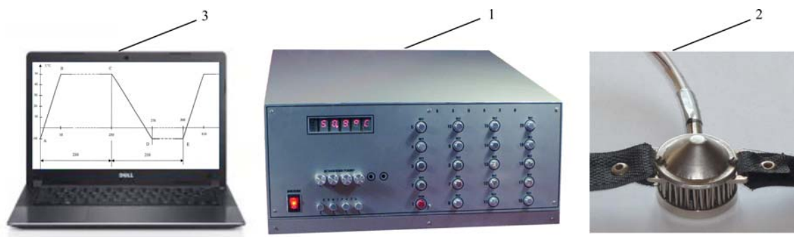
Рис. 1. Термоэлектрический прибор для рефлексотерапии «АЛТЕК-7009»: 1 – блок питания и управления прибора, 2 – термоэлектрический зонд, 3 – персональный компьютер (ПК).
