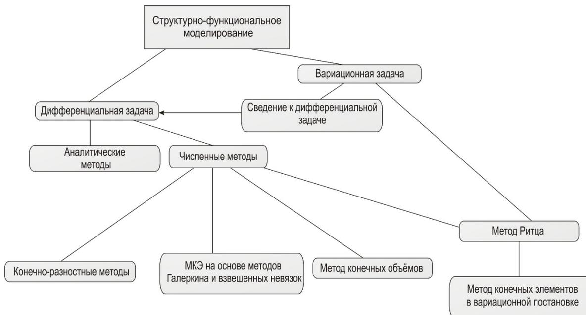
Рис. 4. Классификация методов структурно-функционального моделирования.
