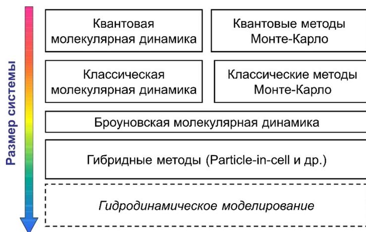
Рис. 8. Классификация методов имитационного моделирования.
