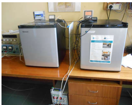
Рис. 4. Сравнимые объекты во время параллельных испытаний: слева – холодильник Ravanson LK – 48, справа – холодильник ХТТ – 48 – 1.
