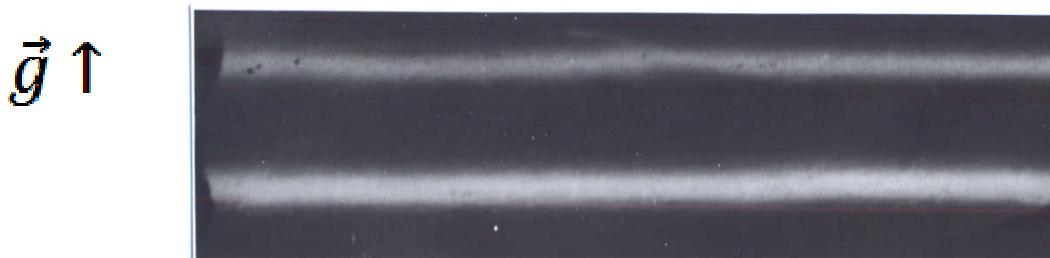
Рис. 1 Топограмма кристалла CdSb : 0.005 ат. % Te . SiKa – излучение, отражение (004). \times 12 .
