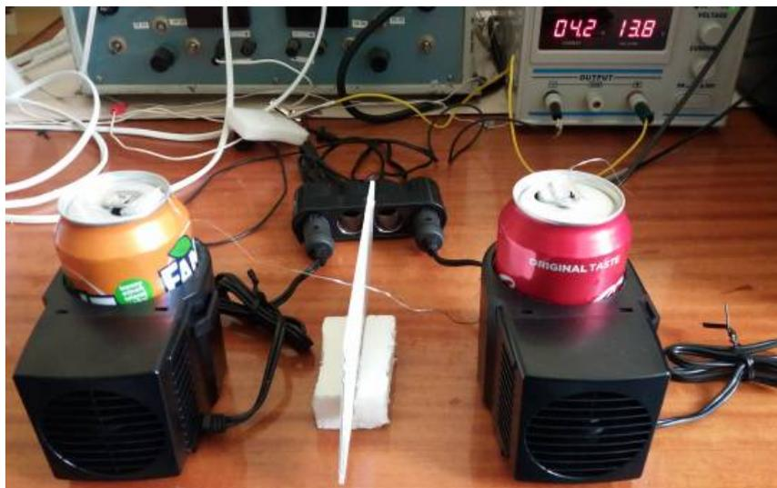
Рис. 8. Фрагмент сравнительных испытаний охладителей напитков *Car mini-cooler* ФМ 201.001.
