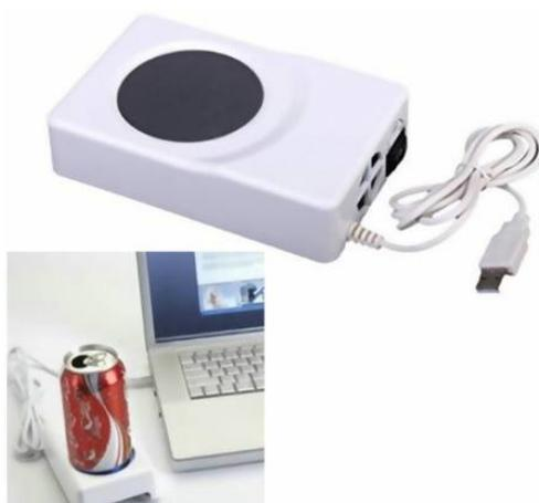
Рис. 6. Охладитель-подогреватель, питаемый от компьютера через порт USB.
