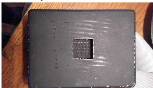
Рис. 3. Матричный термоэлектрический приемник непрерывного излучения.
