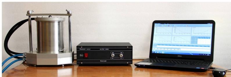
Рис. 17. Внешний вид автоматизированной установки для определения свойств термоэлектрического материала в интервале температур 30 – 900 °С.
