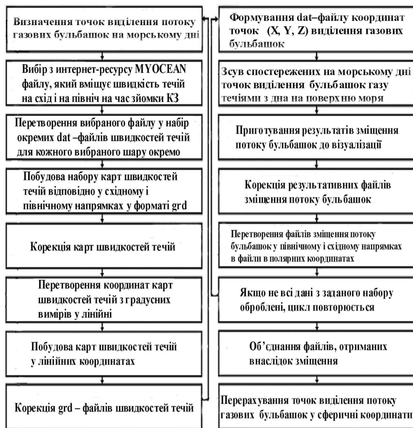
Рис. 1. Блок-схема вирішення прямої задачі. Визначення координат точок аномалій понижених температур поверхні моря, що утворюються при виносі холодних природних вод бульбашками газу при спливанні з дна моря з врахуванням течій
