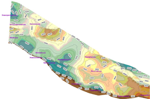
Рис. 2. Карта товщин осадових відкладів між поверхнею фундаменту та поверхнею серпухівського ярусу нижнього карбону (за матеріалами Лукіна О. Ю.) [1] Умовні позначення див. рис. 1.
