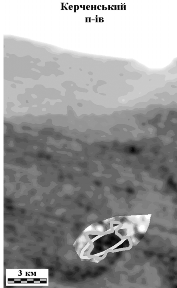
Рис. 2.35. Просторове у плані зіставлення виділеної на знімку Landsat TM (05.05.1992 р., 6-й, тепловий, канал, 10.4–12.5 мкм) теплової аномалії (темно-сірий колір) з контуром локального склепіння Керченської структури (світло-сірий колір, горизонт відбиття Па — нижня частина відкладів майкопської серії)
