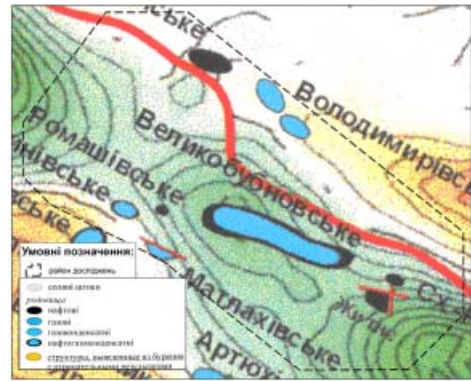
Рис. 2.83. Фрагмент схеми залишкових аномалій гравітаційного поля
