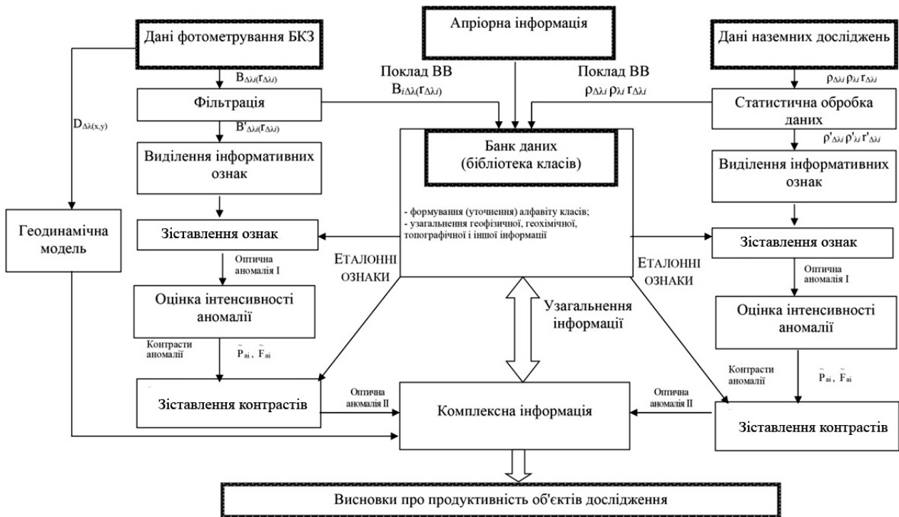
Рис. 1. Технологія обробки результатів дистанційних та наземних фотометрувань
