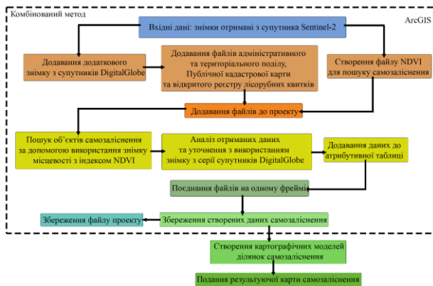
Рис. 2. Структурна схема методики визначення самозаліснених ділянок за даними ДЗЗ
