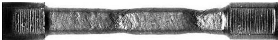
Рис. 6. Шийкоутворення в зразку з 47% Al, продеформованому на розтяг за температури 700 °С зі швидкістю 10^{-5} \text{ c}^{-1} .
