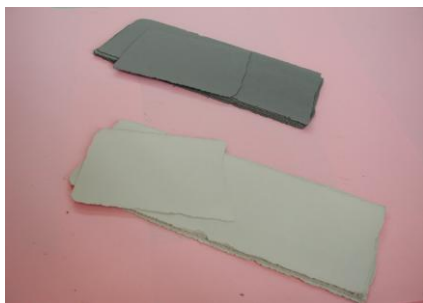
Рис. 1. Прокатані стрічки з порошоків SiC\text{—}15\% (об.) ZrB_2 и SiC\text{—}30\% (об.) ZrB_2 .
