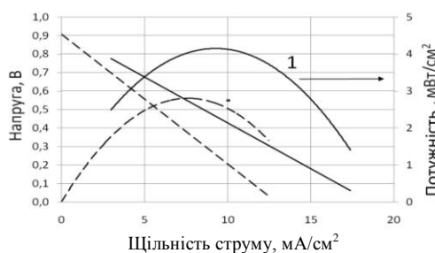
Рис. 3. Вольт-амперні характеристики керамічних комірок, виготовленої в Лабораторії КПК (1) та комерційної (2).
