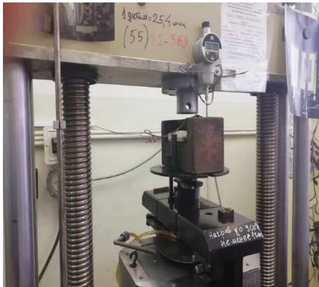
Рис. 8. Загальний вигляд комірки для випробувань на повзучість при вигині (а) та схема оснастки на триточковий вигин (б).
