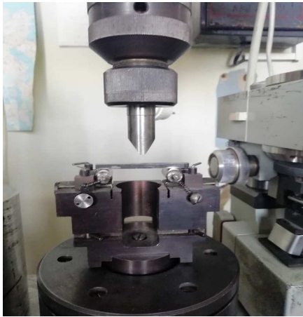
Рис. 2. Загальний вигляд комірки за триточковим згином (база 40 мм) машини CeramTest.
