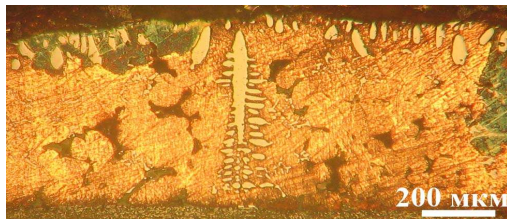
Рис. 5. Мікрофотографії, отримані зі шліфа краплі Ag—39Cu, застиглої на поверхні ZnO-кераміки ( \times 400 ): а — безпосередньо після виготовлення шліфа; б — після витримки на повітрі.
