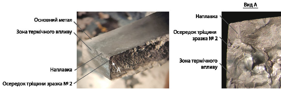
Рис. 6. Фотографія фрагменту зламу зразка № 2.
