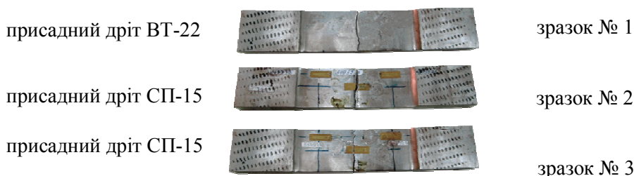
Рис. 3. Зовнішній вигляд зразків, які пройшли втомні випробування.
