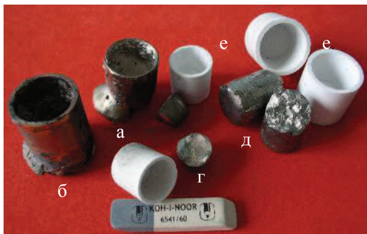
Рис. 1. Зразки хімічно агресивних сплавів Cu—Ti після плавлення при 1473 К в тиглях з матеріалів: а — \text{Al}_2\text{O}_3 ; б — графіт; в , д — сплави з великим вмістом титану (>50% (мас.)); е — фторидні тиглі.
