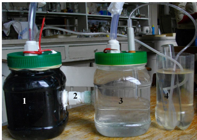
Рис. 1. Лабораторний зразок МПЕ: 1 – анодна камера; 2 – сольовий агаризований місток; 3 – катодна камера; 4 – газозбірна камера.
