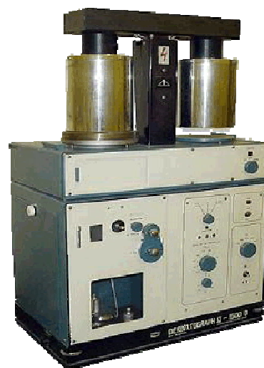
Рис. 2. Функціональна схема та зовнішній вигляд дериватографа Q -1500: 1 – керамічна труба; 2 – утримувач зразка; 3 – піч; 4 – перемикач регулятора нагрівання; 5 – підсилювач; 6 – магніт; 7 – обмотка; 8 – ваги; 9 – диференціальний трансформатор для перетворення сигналу тг; 10 – підсилювач; 11 – пристрій реєструвальний; 12 – підсилювач.
