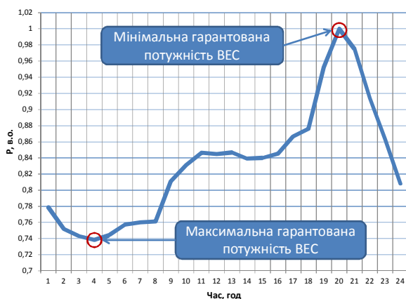
Рис. 6. Приклади визначення (а) та використання (б) мінімальної та максимальної гарантованої потужності ВЕС.
